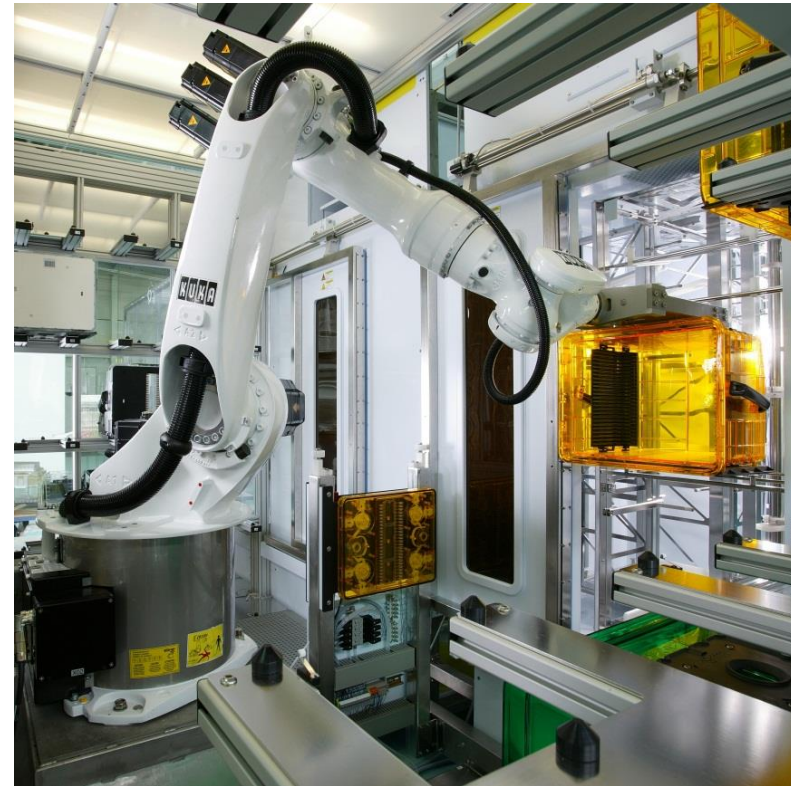
走行軸に載った 大型ロボットによる FOUPの搬送の自動化
