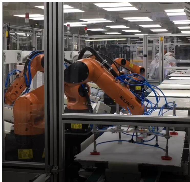
ディスプレイの 組み立て工程の自動化
