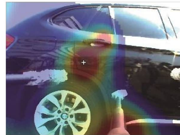
B ドア当たり音と地面反射音の合成音
