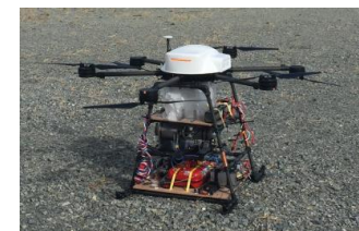
YSEC製ジェットジェネレータ を搭載したドローン試作機
